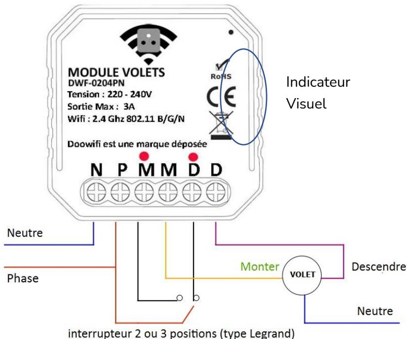
**Après la connexion des fils, remettez le disjoncteur électrique principal, vous verrez l'indicateur lumineux clignote rapidement (1 fois/seconde). Cela indique que le module est en mode d'appairage.**
