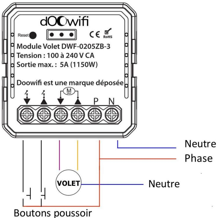
Après la connexion des fils, remettez le disjoncteur électrique principal, l'indicateur lumineux bleu clignote dans le module. Cela indique que le module est en mode d'appairage.
