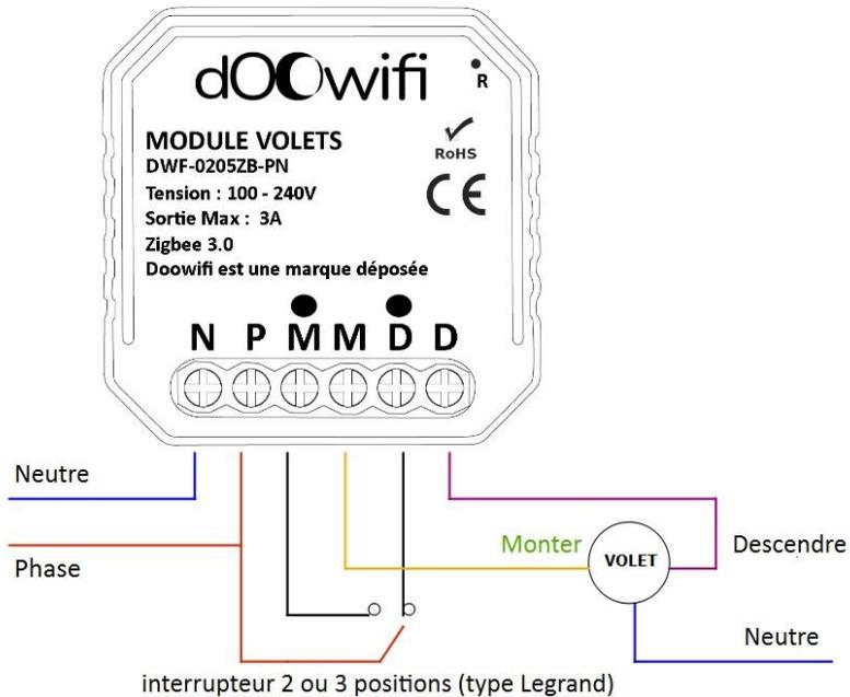
**Après la connexion des fils, remettez le disjoncteur électrique principal, l'indicateur lumineux bleu clignote dans le module. Cela indique que le module est en mode d'appairage.**
