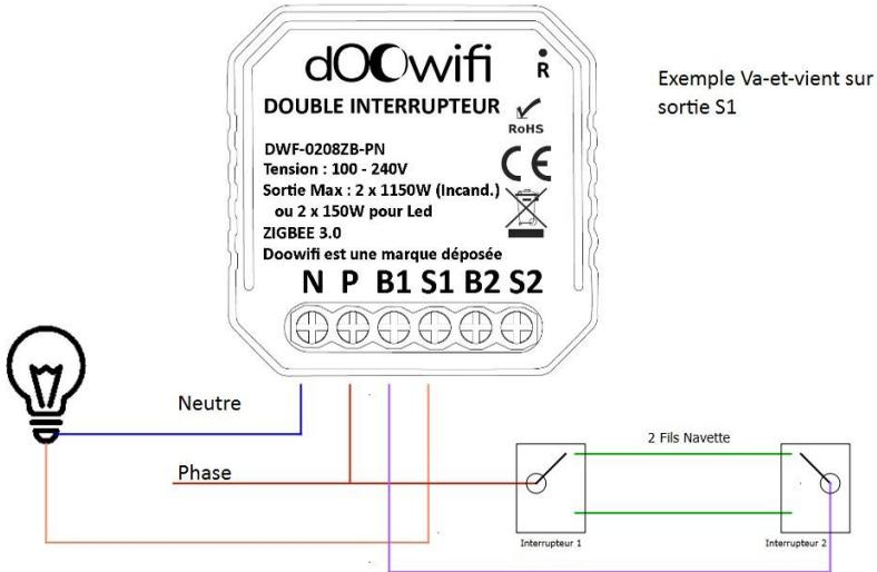
Après la connexion des fils, remettez le disjoncteur électrique principal, l'indicateur lumineux bleu clignote dans le module. Cela indique que le module est en mode d'appairage.
