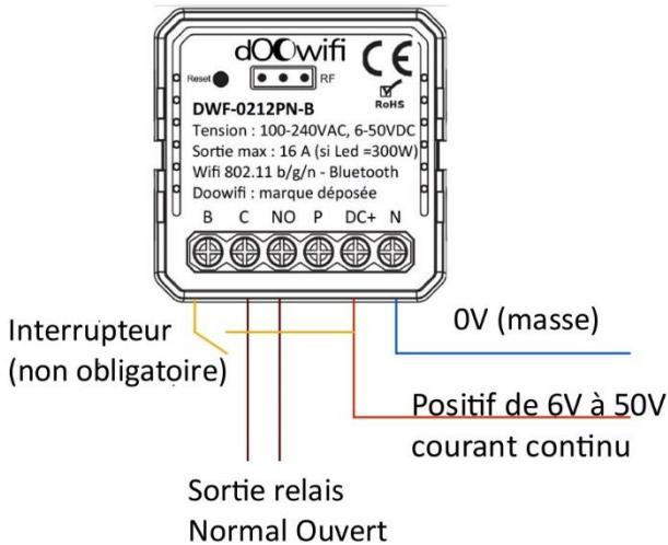
**Après la connexion des fils, remettez le disjoncteur électrique principal, l'indicateur lumineux dans le module clignote rapidement. Cela indique que le module est en mode d'appairage.**
