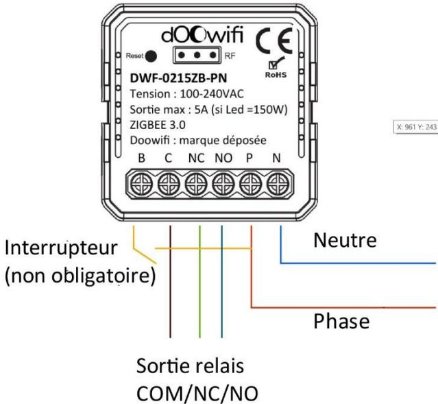
**Après la connexion des fils, remettez le disjoncteur électrique principal, l'indicateur lumineux dans le module clignote rapidement. Cela indique que le module est en mode d'appairage.**
