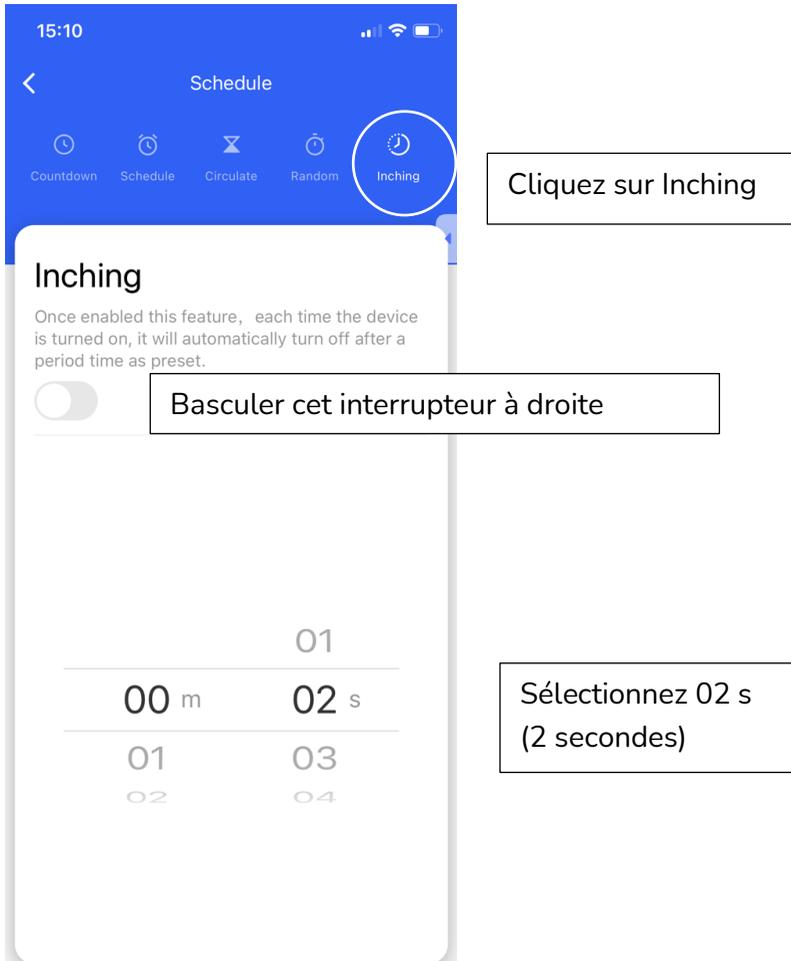
Cette fonction permet la création d'une impulsion. A chaque fois que vous mettez l'interrupteur en ON, il sera basculé automatiquement sur OFF après 2 secondes.
