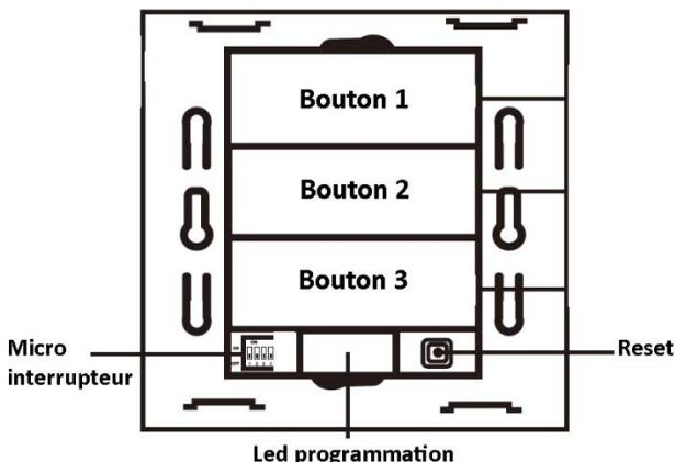
Les micro-interrupteurs 1 et 2 doivent être sur OFF. Les micro-interrupteurs 3 et 4 définissent la fonction intégrée :
