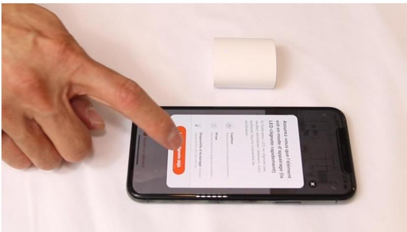
L'application recherche le module Zigbee sur le réseau
