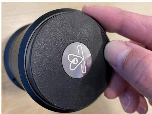
Dévissez puis enlever le compartiment des piles. Utilisez 3 piles au Lithium CR123. Vérifiez la polarité des piles avant de les mettre dans le compartiment des piles. Remettez le compartiment en place puis revisser.
